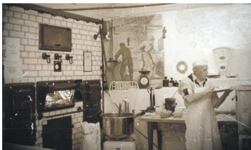
Eine frühere Backstube, der Backofen wurde mit Holz bzw. Kohle befeuert. Quelle: www.kerstins-nostalgia.de
