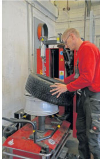
Mit dieser Maschine werden die Reifen von der Felge gezogen.
