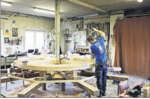
ne Breite von 1,20 m haben. Derzeit entstehen in der Werkstatt die Radkränze und die beiden Radkreuze aus Lärchenholz. Parallel dazu werden die eisernen Schaukeln vorbereitet und verzinkt. Voraussichtlich im Januar 2016 wird das Rad auf dem Hof der Schloßmühle montiert und anschließend in die bereits seit längerem fertige Radgrube eingehoben. Zu diesem Zeitpunkt werden wir uns wieder mit aktuellen Bildern melden.
