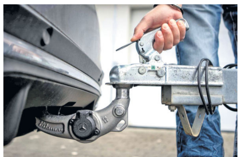
Wichtig: Unbedingt prüfen, ob der Deichselkopf richtig eingerastet ist.
